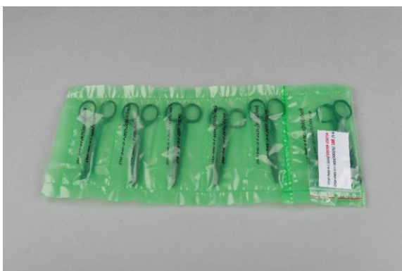
Fot. 12. Zabezpieczenie obiektów folią antykorozyjną (fot. D. Ren).
